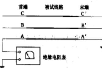
图4 用绝缘电阻表核对相别接线示意图
