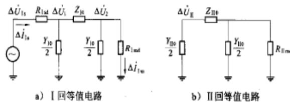
图 23 零序互阻抗双端同步测量等值电路
