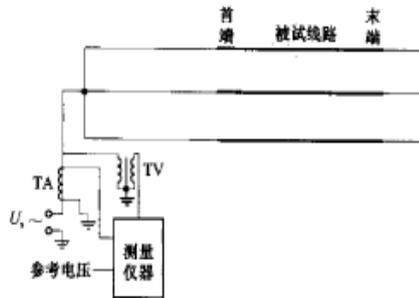
图 17 零序导纳测量示意图（单端法）
