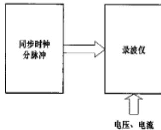
图 28 分立式同步测量系统总体结构
