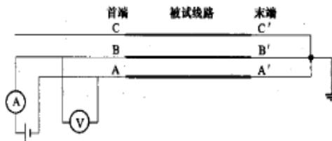
图 7 直流电阻测量示意图
