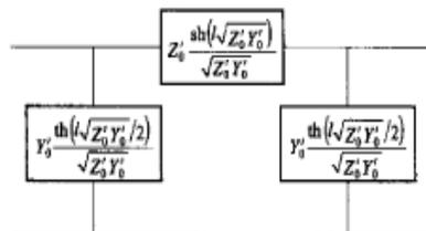
图 27 被试线路的零序等值  $\pi$  模型
