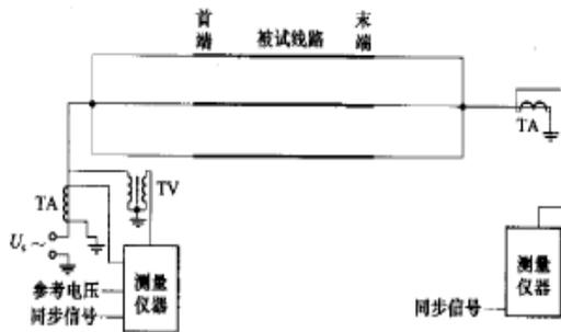
图 16 零序阻抗测量示意图（双端法）
