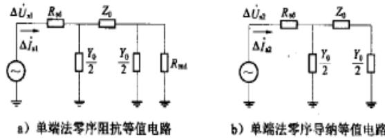
图 19 零序参数的单端测量等值电路
