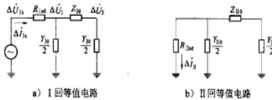
图 25 零序耦合电容双端同步测量等值电路
