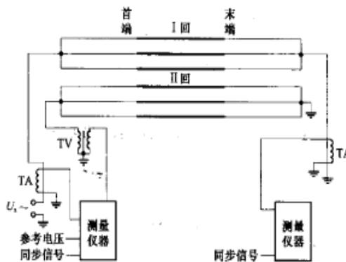
图 22 零序互阻抗测量示意图
