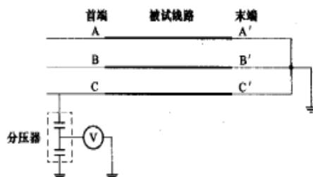
图 1 电磁感应电压测量示意图
