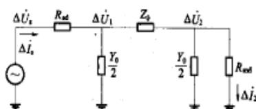
图 21 零序阻抗双端同步测量等值电路
