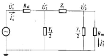
图 14 正序阻抗双端同步测量等值电路
