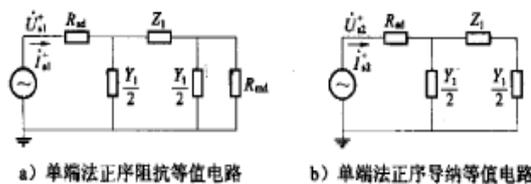
图 12 正序参数的单端测量等值电路
