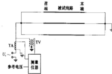
图 15 零序阻抗测量示意图（单端法）
