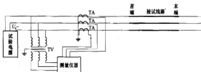
图 8 正序阻抗测量示意图 (单端法)
