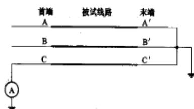
图3 接地电流测量示意图
