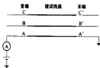
图5 用直流电流核对相别接线示意图
