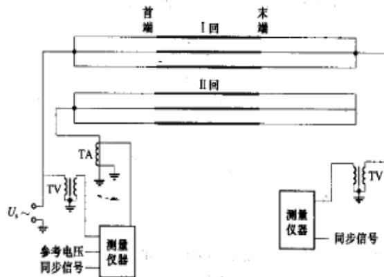
图 24 零序耦合电容测量示意图
