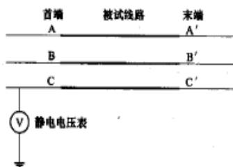
图2 静电感应电压测量示意图
