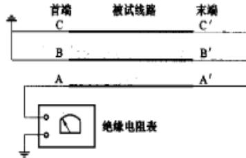
图 6 测量线路各相绝缘电阻接线示意图
