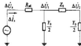
图 20 零序导纳双端同步测量等值电路
