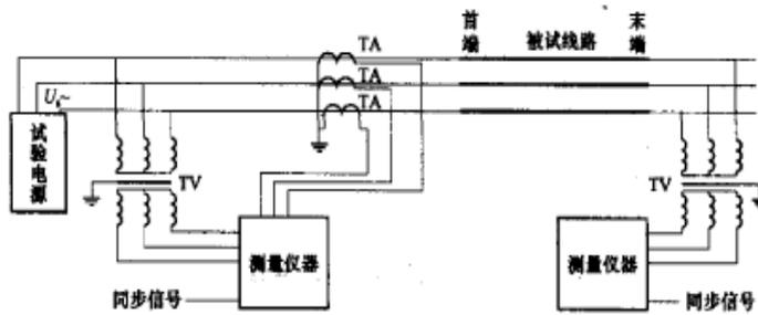
图 11 正序导纳测量示意图（双端法）
