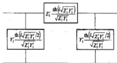
图 26 被试线路的正序等值  $\pi$  模型
