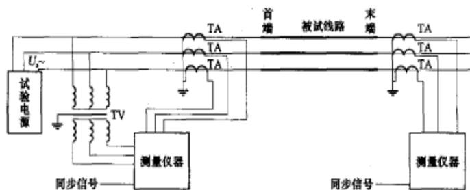
图 9 正序阻抗测量示意图 (双端法)
