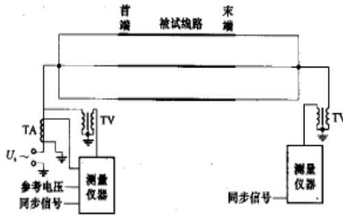
图 18 零序导纳测量示意图（双端法）
