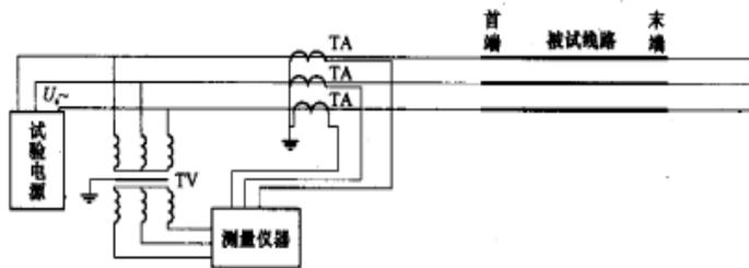
图 10 正序导纳测量示意图（单端法）
