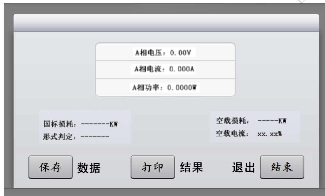
图八 单相空载测试
