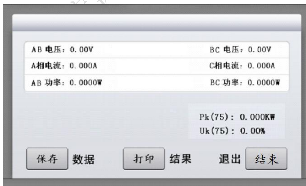
图十一 两元件法负载测试
