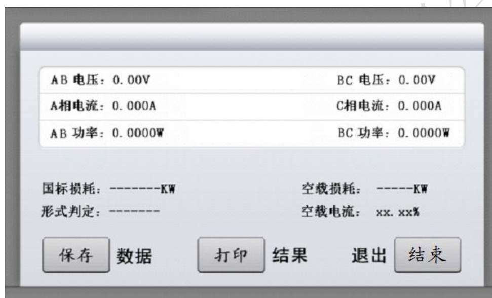
图七 两元件法空载测试
