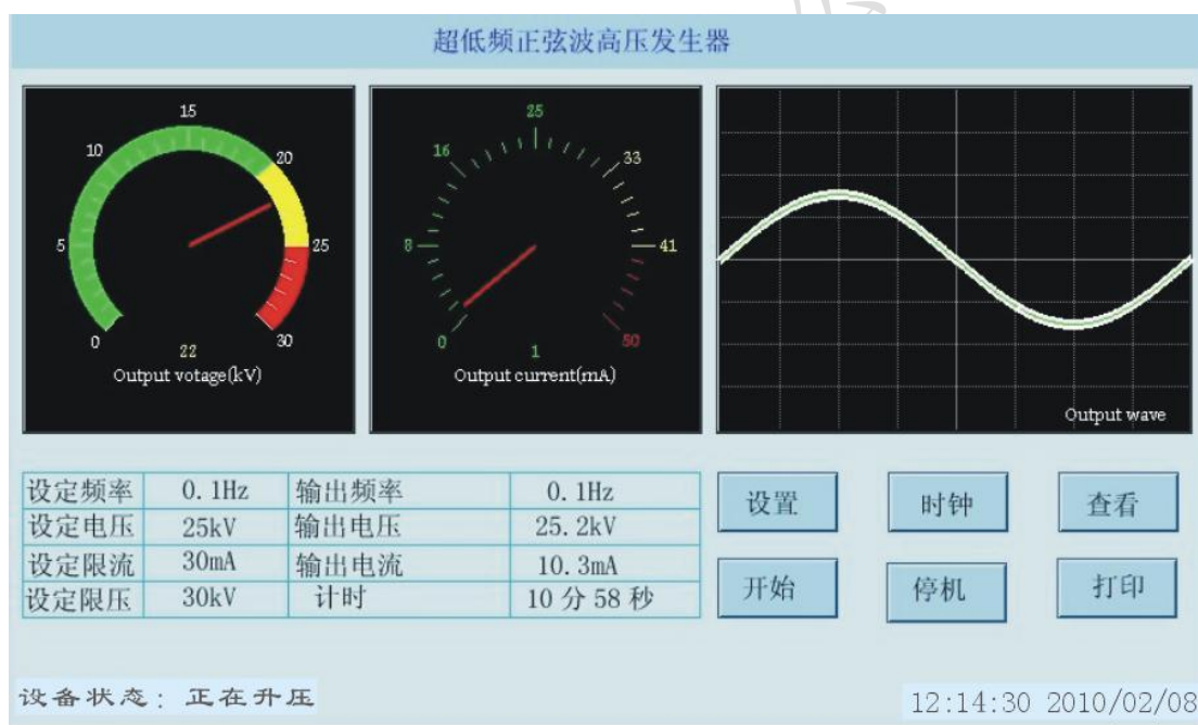
图 7 控制器提示正在升压
