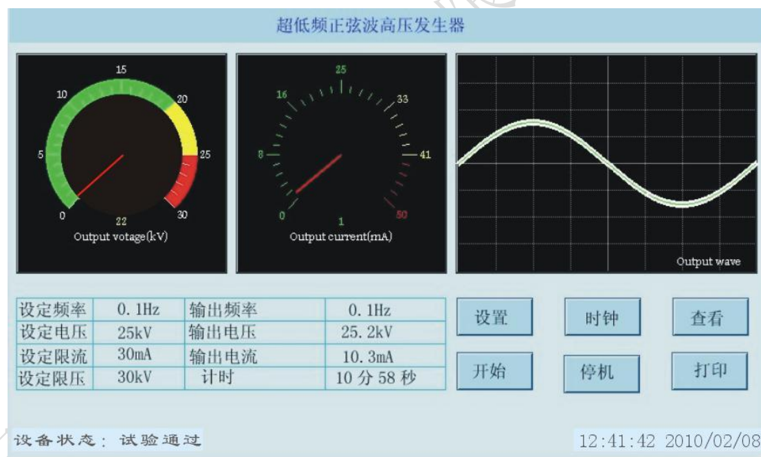
图 11 控制器提示试验通过
