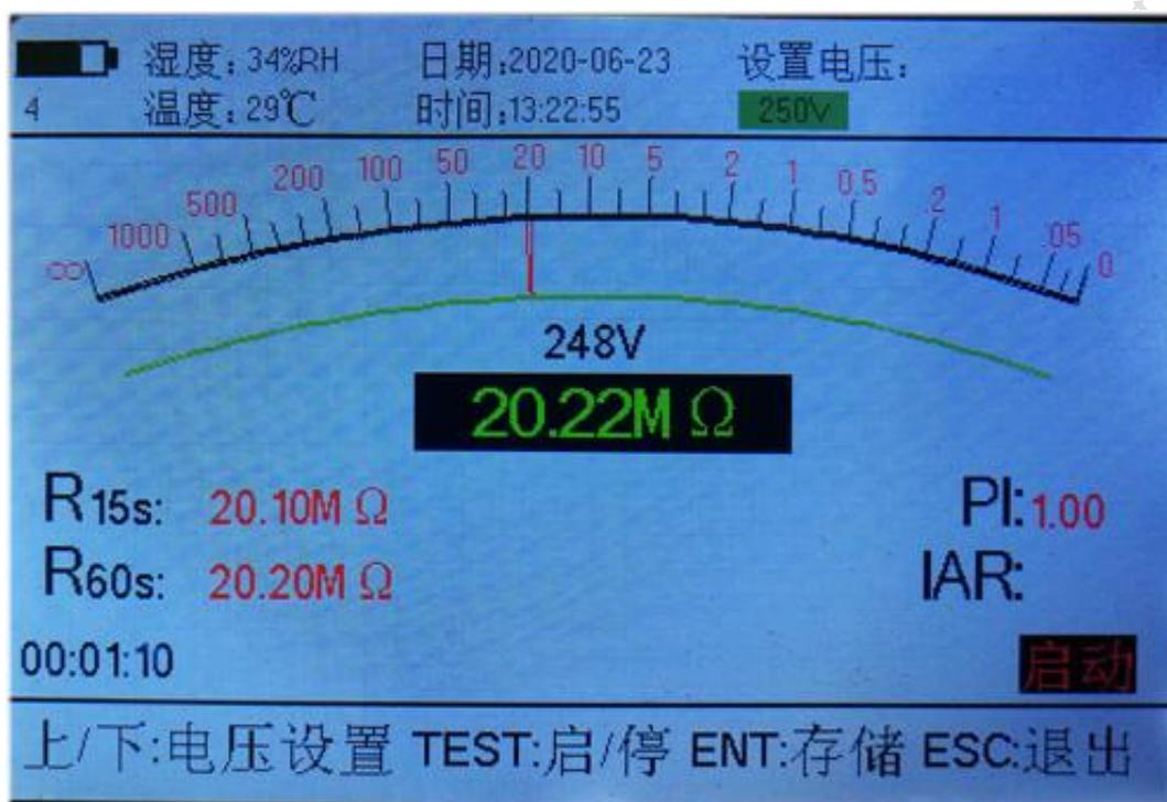
(3) 在测试界面下，点击“ENT”键可以对当前测试状态进行保存，存储时界面提示“正在存储”。
