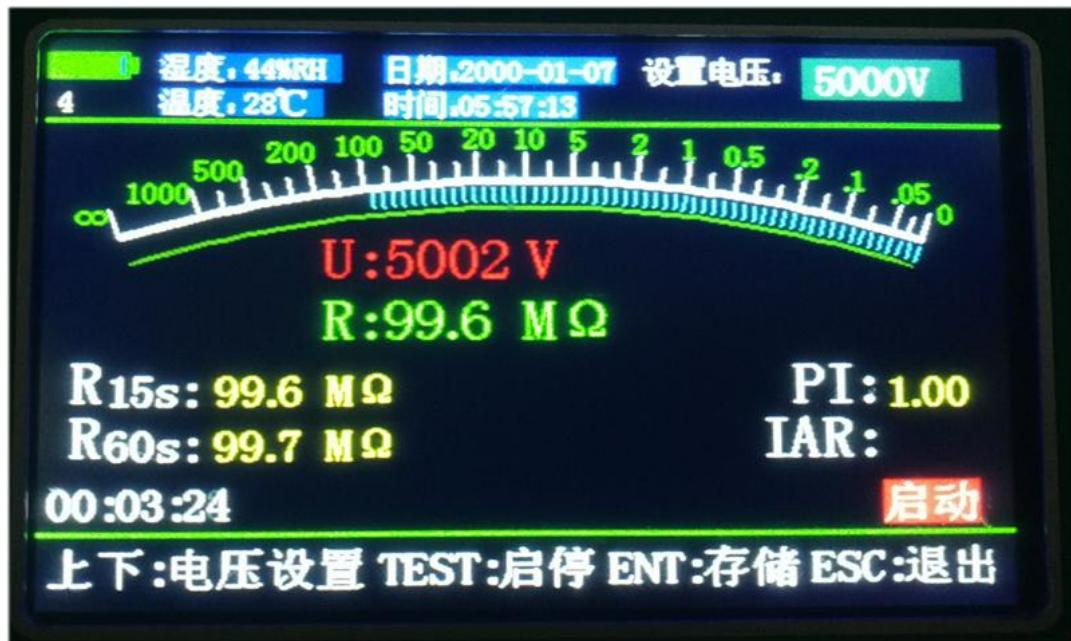
(3) 在测试界面下，点击“ENT”键可以对当前测试状态进行保存，存储时界面提示“正在存储”。
