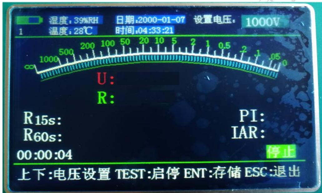
(1) 用“上”“下”键进行选择合适的输出电压：250V、500V、1000V、2500V、5000V、10000V
