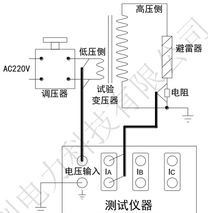
说明：（1）按照不同的电压等级，避雷器上所施加的电压由升压试验变压器产生。
